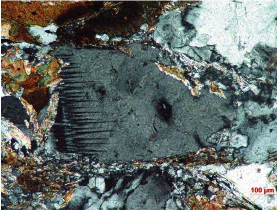
**Fotomicrografia 9:** Ortognaisse menos deformado. Geminação polissintética em grão de plagioclásio terminando em pontas, indicativo de que é gerado pela deformação, Ponto BSG 41. NC
