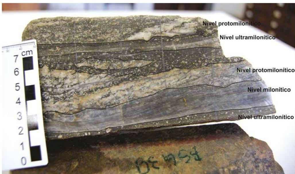
**Foto 15:** Amostra do ponto BSG 39. Ortognaisse milonítico com três níveis de intensidade de deformação.
