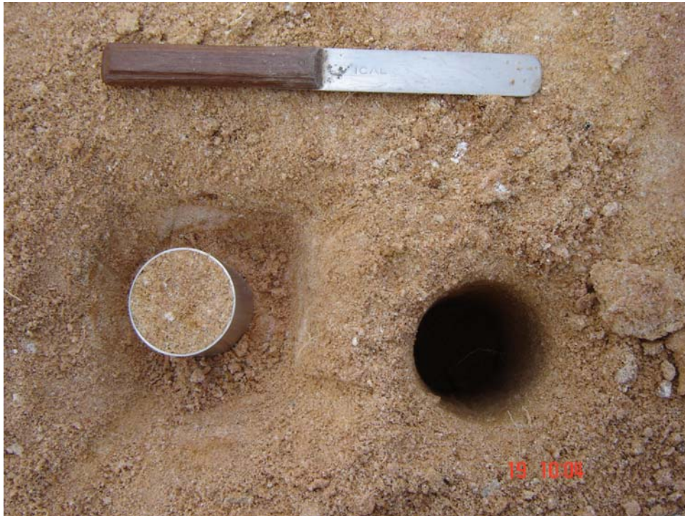
Figura 13 - Amostra semideformada coletada ao lado da sondagem realizada para o ensaio de Guelph.
