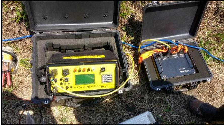
Figura 18 - Equipamento utilizado na aquisição de CE– Resistivímetro (*SuperSting*) (Fonte: MOSAIC, 2017b).
