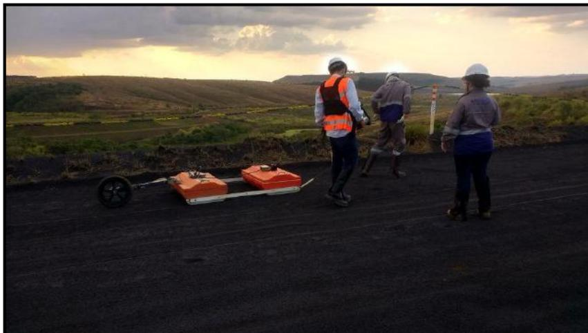
Figura 19 - Aquisição de GPR realizada na região da crista do barramento (Fonte: MOSAIC, 2017b).
