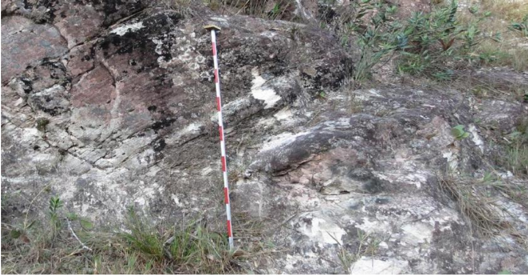
Figura 7 – Vara de Jacob, instrumento confeccionado para medição mais precisa da espessura de camadas basculadas e intervalos encobertos.
