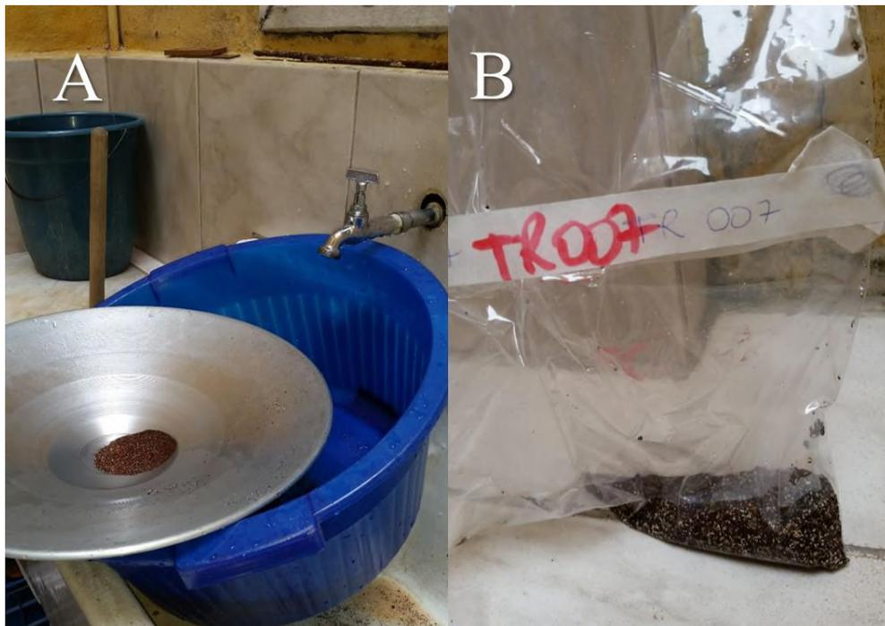
Figura 12 - Processo de concentração por bateia. A – Concentrado obtido no centro da bateia e o material não concentrado na bacia azul sob a bateia; B – Concentrado obtido por bateia armazenado e identificado.
