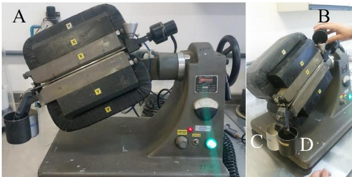
Figura 15 - A – separador isodinâmico Frantz; B – material não atraído pelo ímã de ferrite ou pela amperagem anterior sendo colocado no Frantz; C – material não atraído à amperagem selecionada; D – material atraído à amperagem selecionada.
