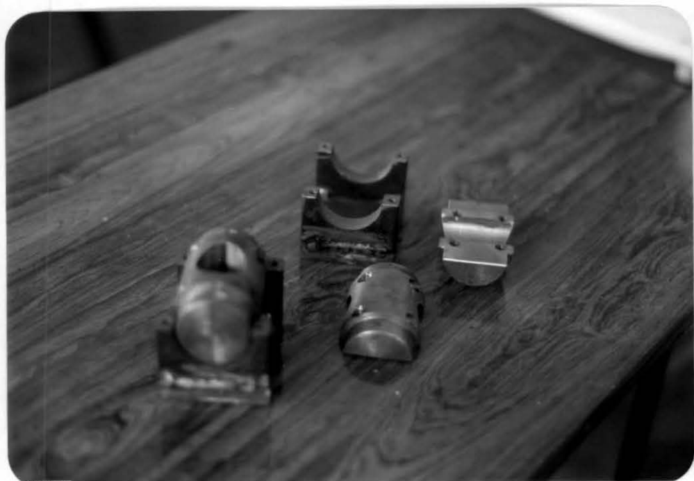
FOTO III.9 - Detalhes dos apoios para fixação dos modelos
