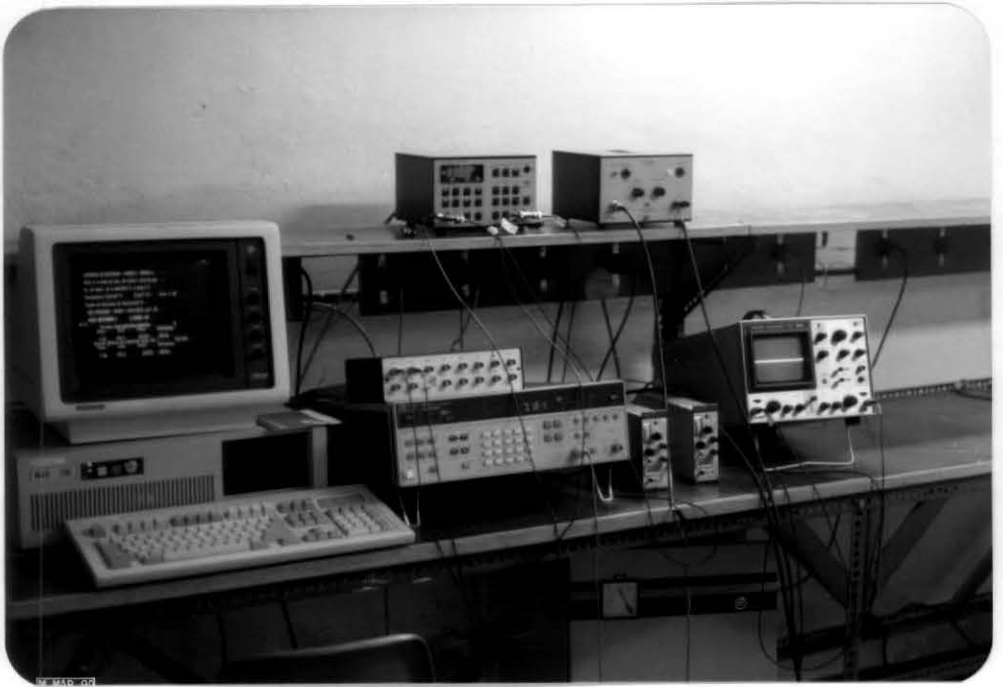
FOTO VI.1 - Equipamentos utilizados para a aquisição automática dos dados e controle dos ensaios
