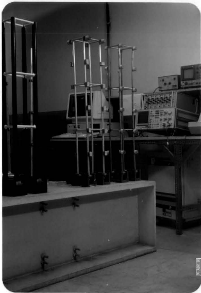
FOTOS IV.2 e IV.3 - Vista dos modelos após o ajuste das frequências naturais
