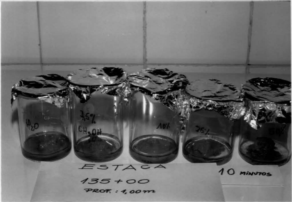
Fotografia III.15a - Ensaio FQ3: Interação do solo com soluções de metanol sob concentrações de 0, 7,5, 10, 25, e 50%, aos 10 min..
