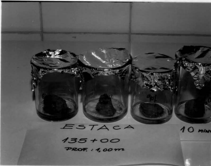
Fotografia III.15a - Ensaio FQ3: Interação do solo com soluções de metanol sob concentrações de 0, 7,5, 10, 25, e 50%, aos 10 min..
