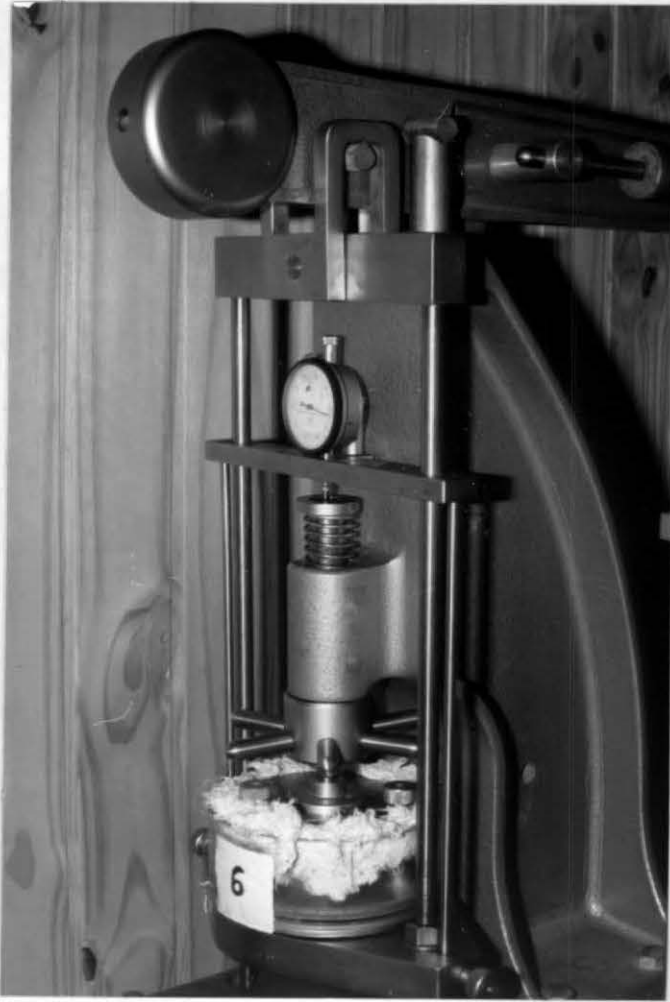
Fotografia III.17 - Proteção da célula oedométrica contra a variação de umidade do corpo de prova.
