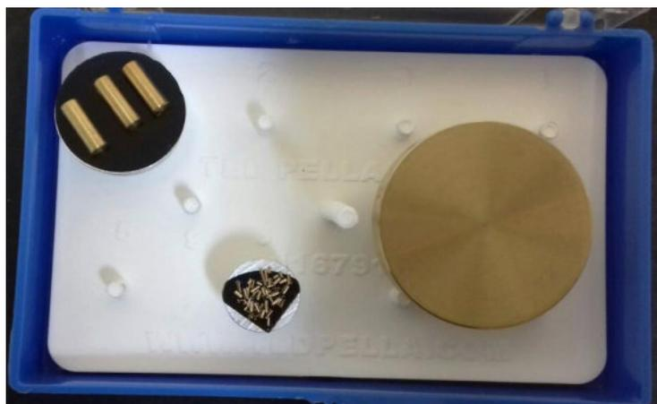
Figura 18: Amostras de latão fixadas por cola de carbono em um disco suporte de metal.
