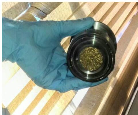
Figura 16: Porta amostra com a limalha de latão, recoberto com filme ultralene.
