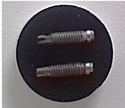
Figura 12: Implante dentário. A parte utilizada para a análise química é no parafuso que fica inserido no osso.
