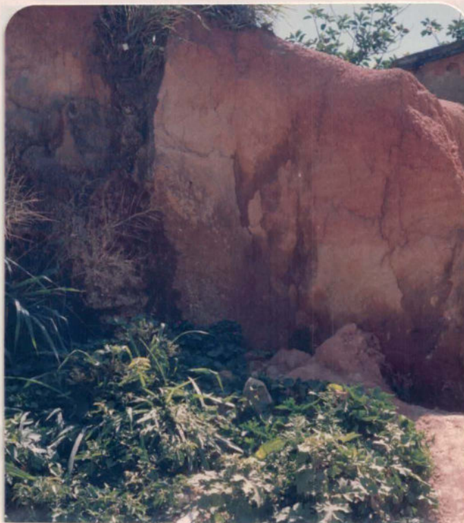
FOTO 10 - Solo residual do gnaisse facoidal podendo-se notar a estrutura da rocha matriz preservada.
