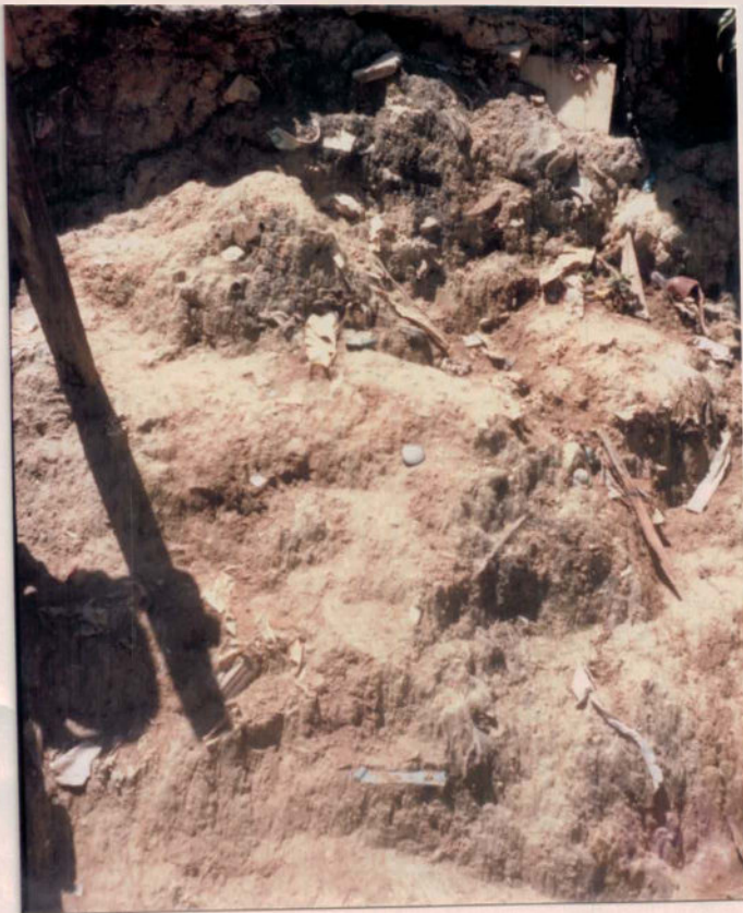
FOTO 30 - Mistura de solo e lixo (solo antrópico) altamente instável.
