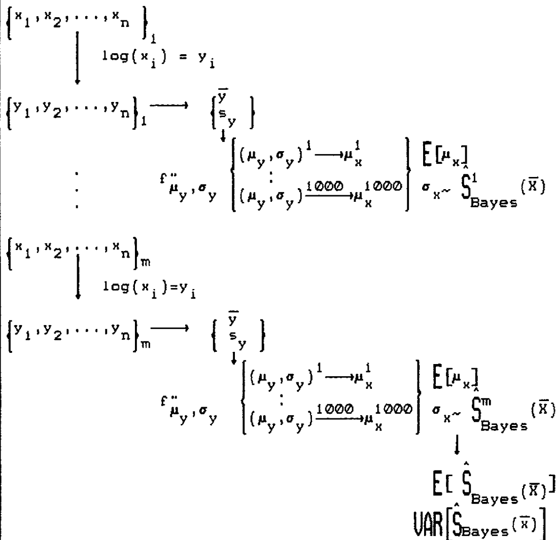
Figura III.2 - Esquema do Método Bayesiano para o Cálculo do Desvio Padrão de \bar{X} .
