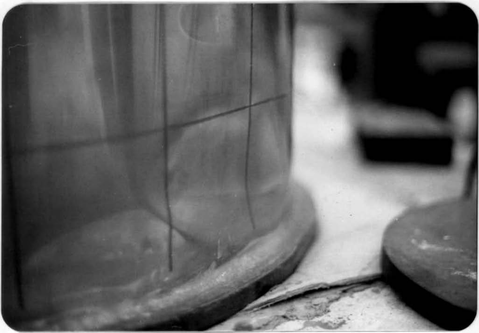
Foto IV.1 - Detalhe da ligação casca-tampa circular mediante silicone
