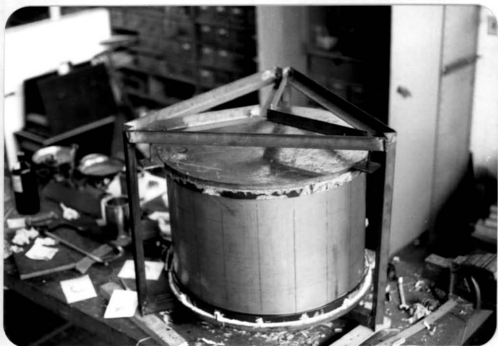
Foto IV.3 - Montagem do modelo experimental para conseguir a condição de engaste
