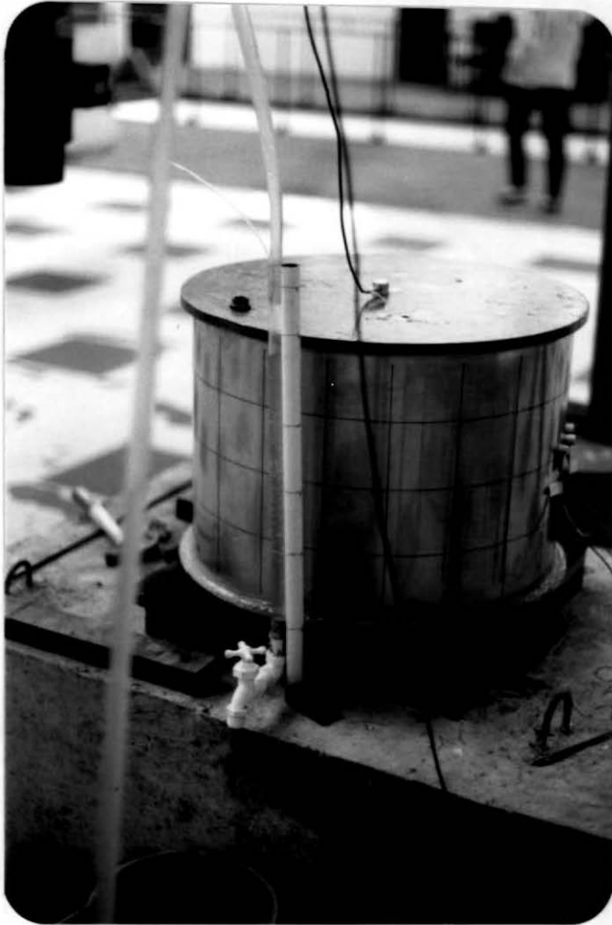
Foto IV.7 - Vista do modelo e detalhe do tubo de medição do nível de fluido
