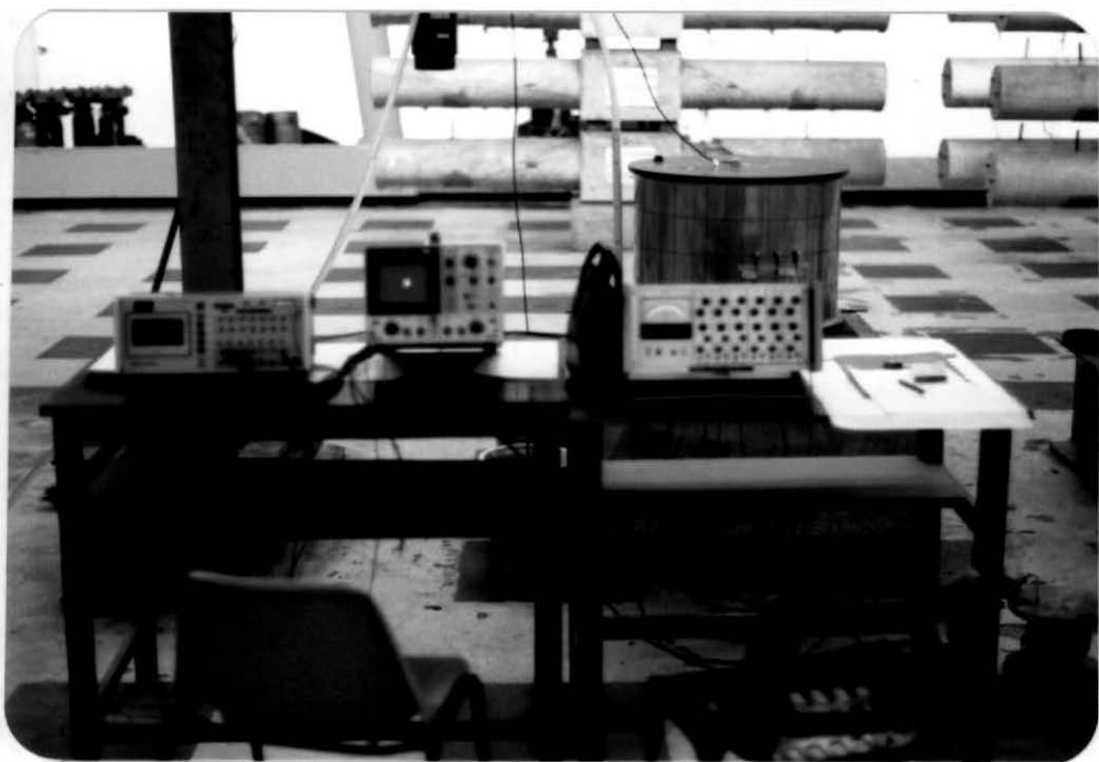
Foto IV.10 - Vista geral da montagem para os ensaios onde pode-se observar parte dos equipamentos usados (amplificador, gravador e osciloscópio)
