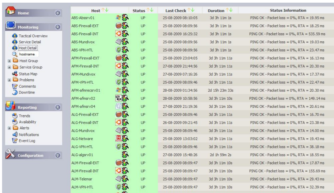
Figura 10 – Nagios apresentando os equipamentos monitorados dos clientes da Huthil
