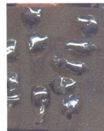
Figura II.1 – Exemplos de soldas bem feitas em uma placa de circuito impresso.
