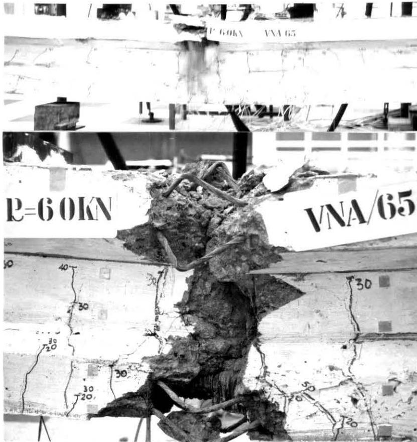
Foto 20 - No momento e após a ruptura da viga VNA/65
