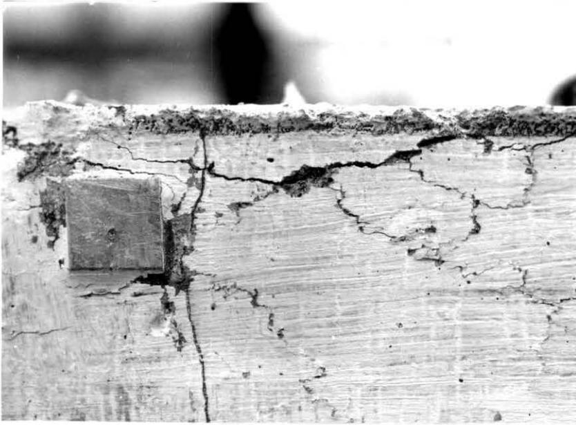
Foto 8 - Esfoliação do concreto instantes antes do esmagamento da zona comprimida.
