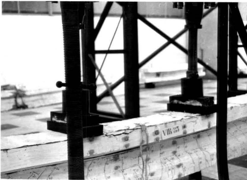
*Fig. 17 - Ruptura lenta da viga VIB/85.*
