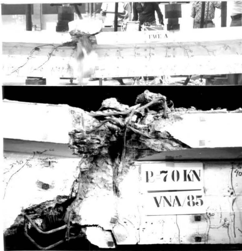
Foto 12 - No momento e após a ruptura da viga VNA/85.
