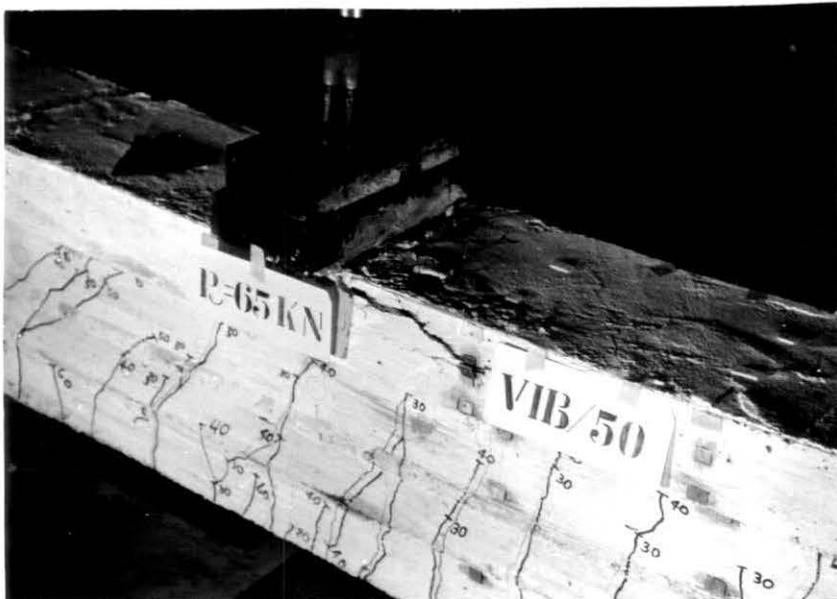
Foto 25 - Ruptura lenta da viga VIB/50
