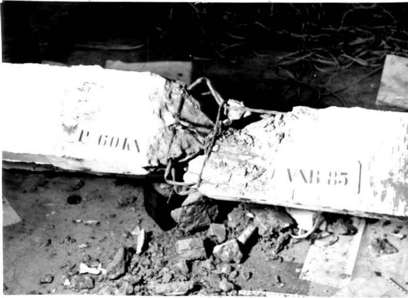
*Fig. 16 - Viga VNB/85 rompida bruscamente.
