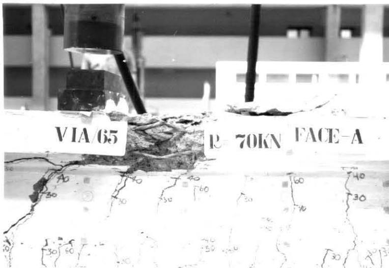
Foto 21 - Viga VIA/65 apresentando a zona comprimida totalmente esmagada.
