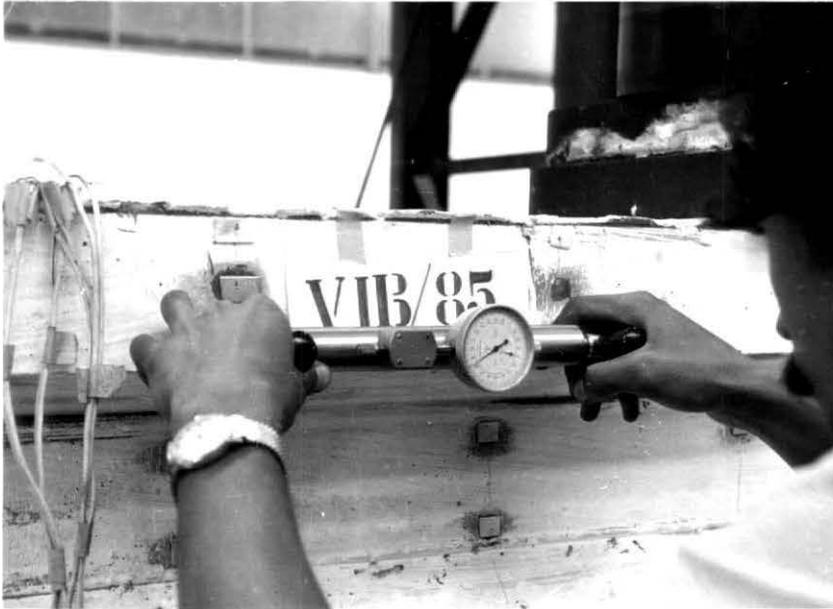
Foto 4 - Detalhe do defômetro - leitura da deformação do concreto.
