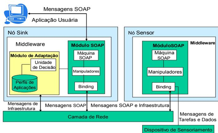
**Fig. 1.** Componentes dos Nós Sorvedouros e Nós Sensores.
