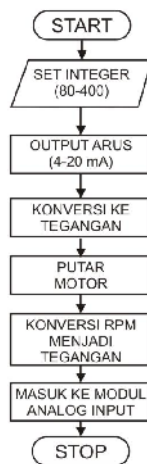
Gambar 9. Flowchart Rangkaian pengendali kecepatan motor
