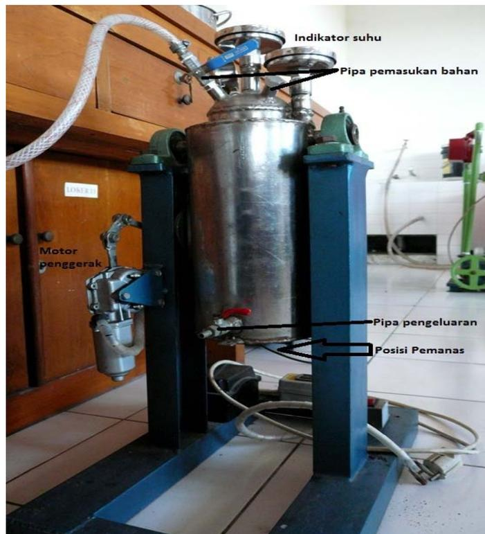
Gambar 4 : Reaktor Hidrogenasi
