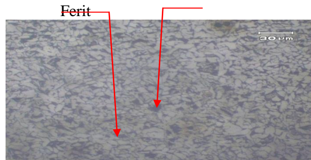
Gambar 2.8 Foto Struktur Mikro Base Metal A (a) E6013 dan (b) E7016
