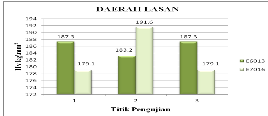
Gambar 2.6 Nilai Kekerasan Pada Daerah Lasan Posisi C
