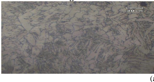
Gambar 2.10 Foto Struktur Mikro Daerah Lasan C
