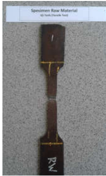
Gambar 7. Hasil pengujian tarik pada raw material
