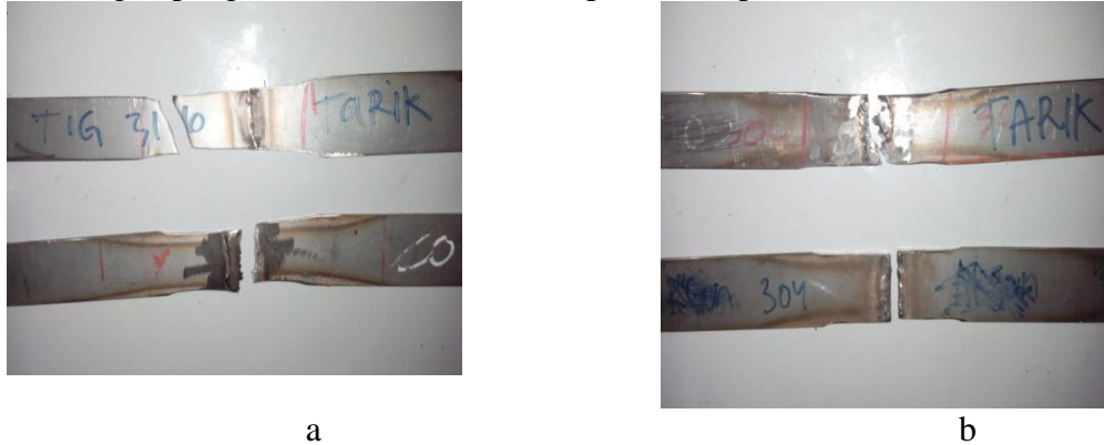
Gambar 5. Hasil uji Tarik dengan Material a) SS316; b) SS304 dengan metode pengelasan TIG dan MIG
