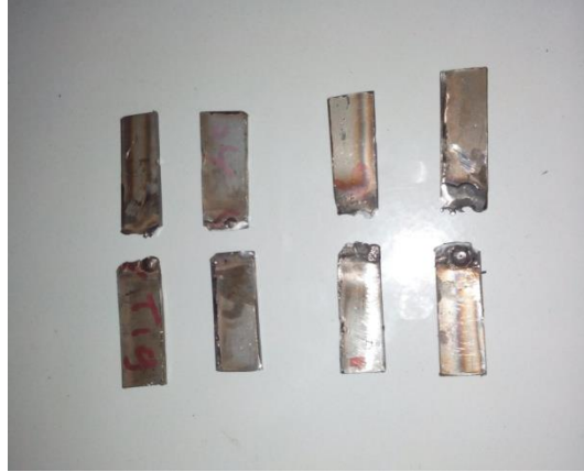
Gambar 4. Hasil uji Impak pada sambungan pengelasan TIG dan MIG pada material SS316 dan SS304
