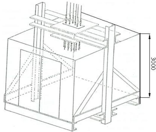
**Gambar 2 Konstruksi kereta Elevator**
