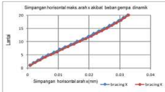
Gambar.4. Simpangan horizontal maksimum akibat beban dinamik untuk bracing X dan K
