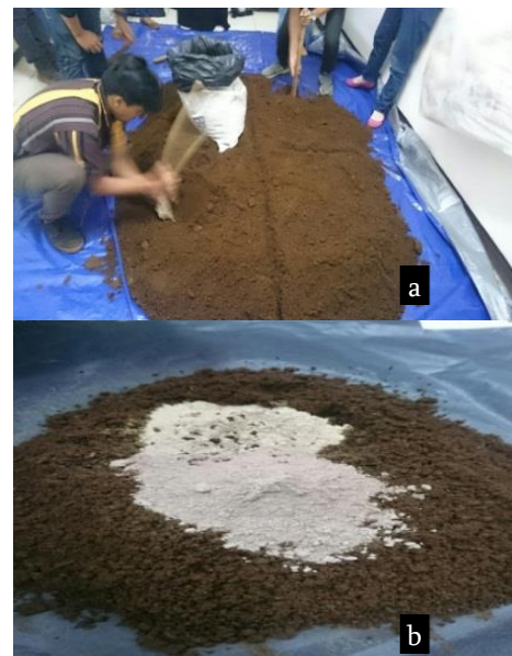
Gambar 2. Persiapan media. (a) Proses pencampuran tanah dari lapangan. (b) Tanah dan amelioran sebelum diaduk.
