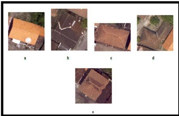
**Gambar 2** Kenampakan atap rumah dari Foto udara ortho, Gambar (a) adalah tipe atap rumah pelana (*gable roof*), gambar (b) adalah tipe atap rumah *cross gabled roof* (pelana modifikasi), gambar (c) adalah tipe atap rumah limas (*hip roof*), gambar (d) adalah tipe atap rumah *cross hipped roof* (limas modifikasi) dan gambar (e) adalah tipe atap joglo
