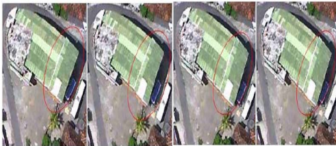
Gambar 3. Jello efek yang membuat geometri bangunan berubah-ubah.
