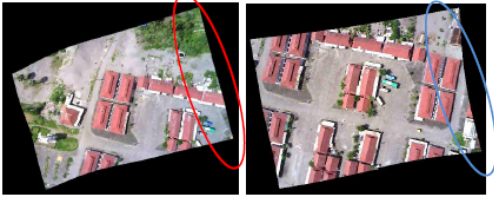
lebar sisi frame yang lebih besar (merah) dibandingkan sisi frame lainnya (biru)
