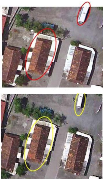
Gambar 7. Mosaik 2D (atas) dan Near-orthomosaic (bawah) dengan relief displacement yang lebih minimum.
