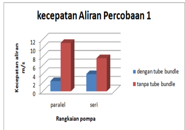
Gambar 14. Grafik Liran Fluida percobaan 1 rangkaian seri dan paralel
