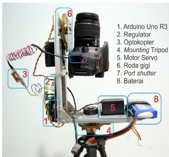
Gambar 3 Perangkat keras sistem secara keseluruhan
