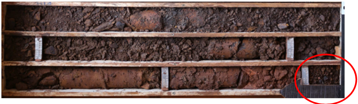
Figura 7.27 – Caixa de testemunhos evidenciando a baixa recuperação. Referente à correlação A (Fonte: acervo Vale / geóloga Priscila Coelho / modificado pelo autor).
