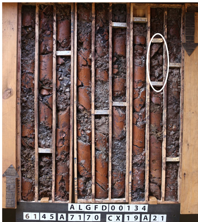
Figura 7.46 – Caixa de testemunhos mostrando a mudança de material referente à correlação I (Fonte: o autor)
