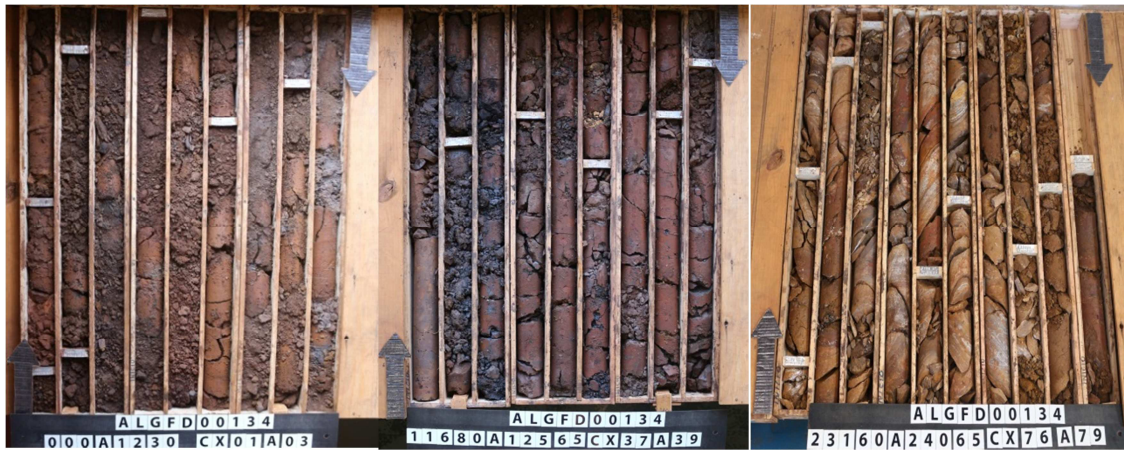
Figura 7.12 - Caixas de testemunhos mostrando litologias e compacidades diferentes (Fonte: acervo Vale/o autor)
