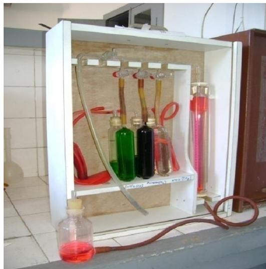
Figura 4.5 - Vista geral do analisador de gás ORSAT.
