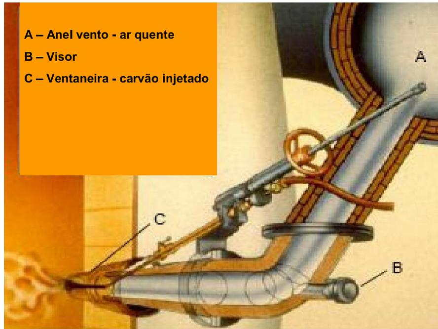
Figura 3.4 - Figura esquemática de injeção de carvão pulverizado em alto-forno através das ventaneiras<sup>[30]</sup>
