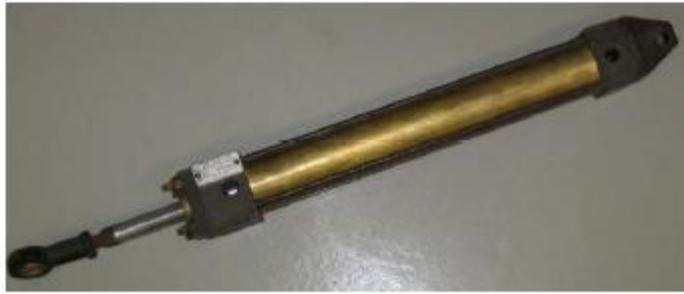
Figura 32 - Cilindro de injeção da resina
