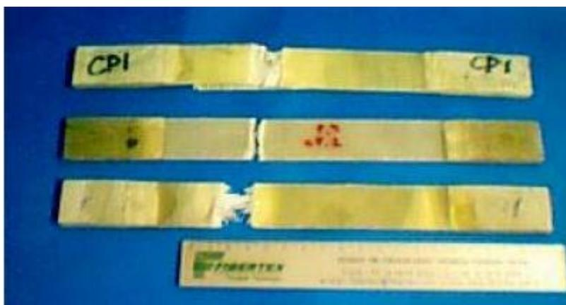
Figura 38 - Corpos de prova rompidos
