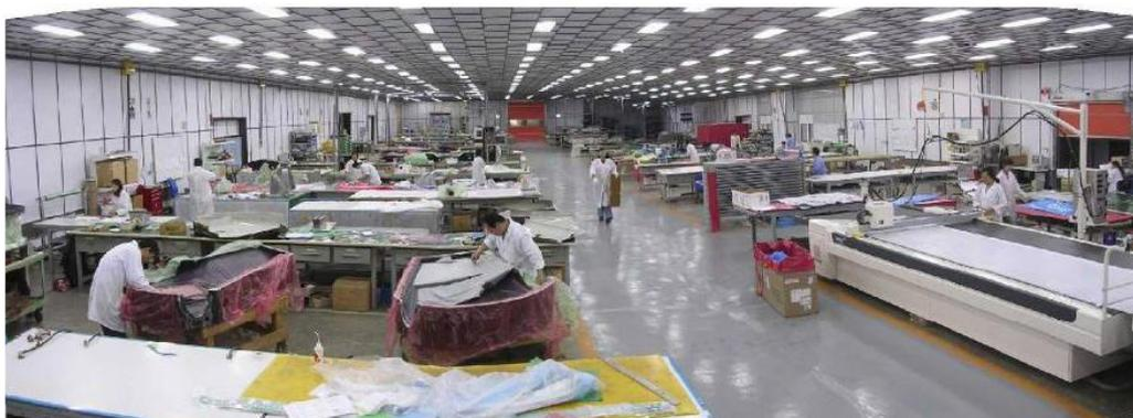
Figura 22 - Fotografia da empresa Argos na preparação de compósitos pré-impregnados
