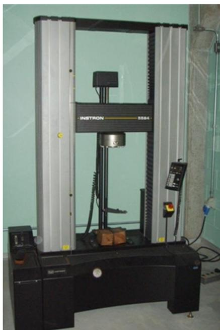
Figura 37 - Máquina universal Instron
