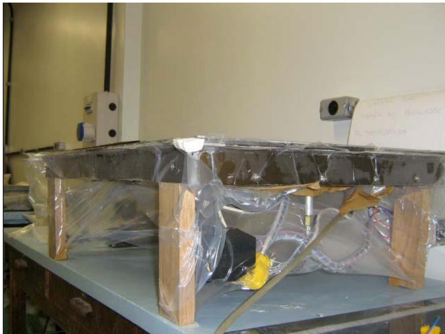
Figura 33 - Revestimento do molde com saco plástico e teste do vácuo
