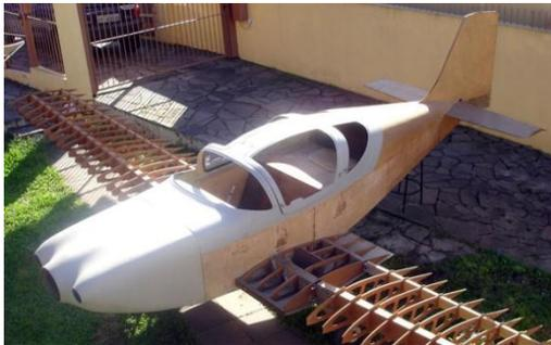
Figura 10 - Aeronave experimental AC 19 Papion em construção
