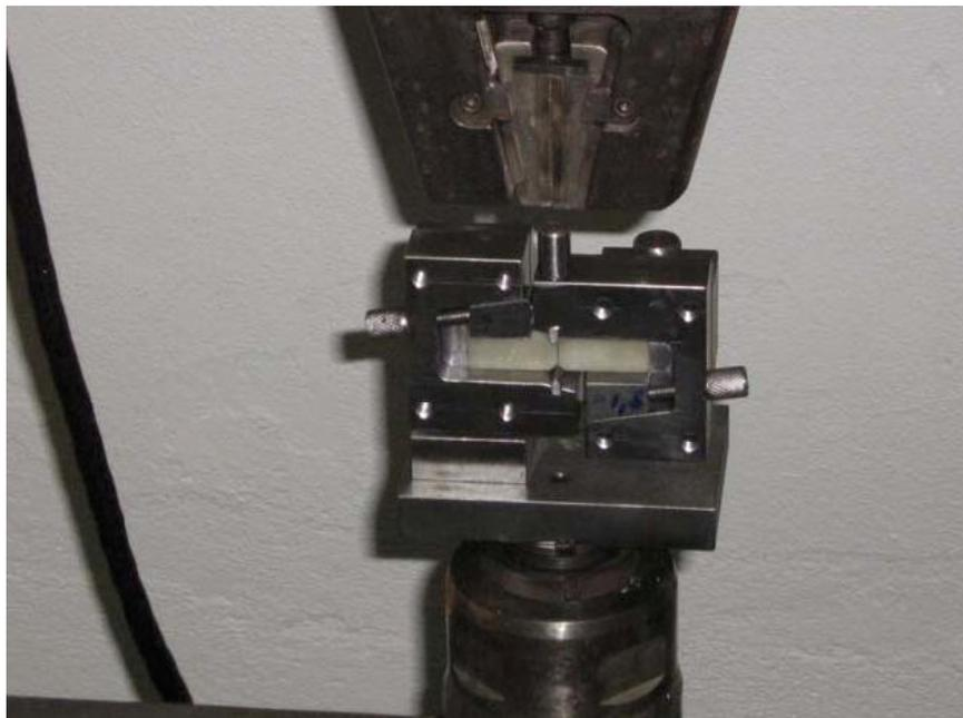
Figura 41 - Dispositivo losipescu para teste de cisalhamento
