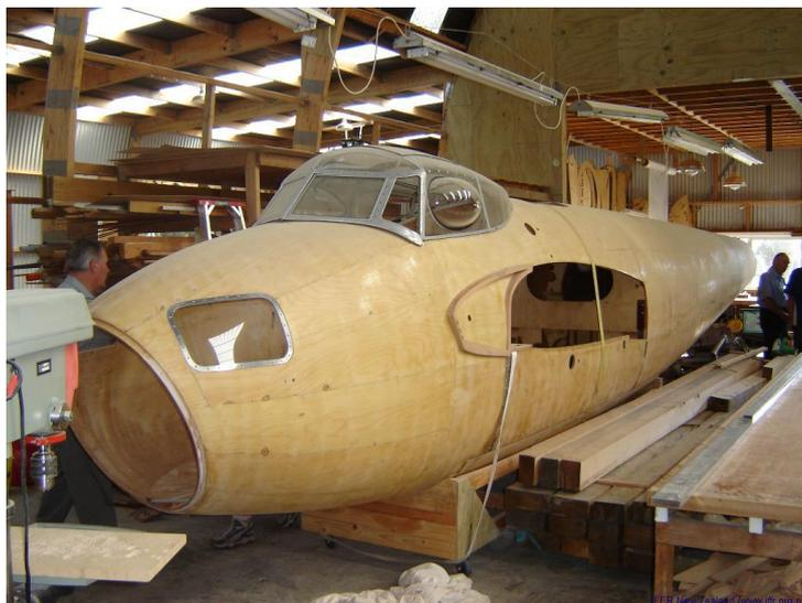
Figura 23 - Imagem da restauração de aeronave DH98 Mosquito, com fuselagem em madeira (contraplacado).
