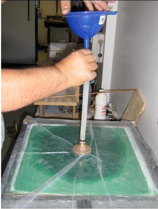
Figura 35 - Teste de infusão de resina no tecido
