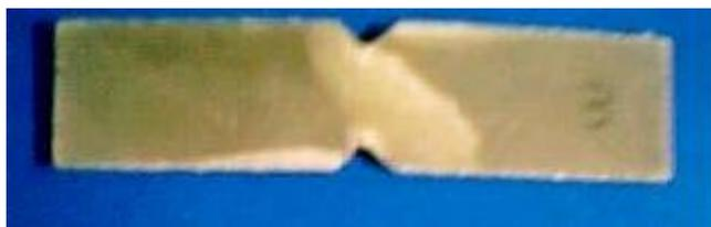
Figura 42 - Corpo de prova rompido por cisalhamento
