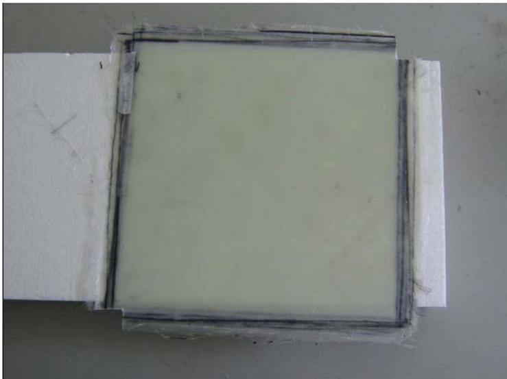
Figura 36 - Placa numero 2 fabricada pelo processo RTM
