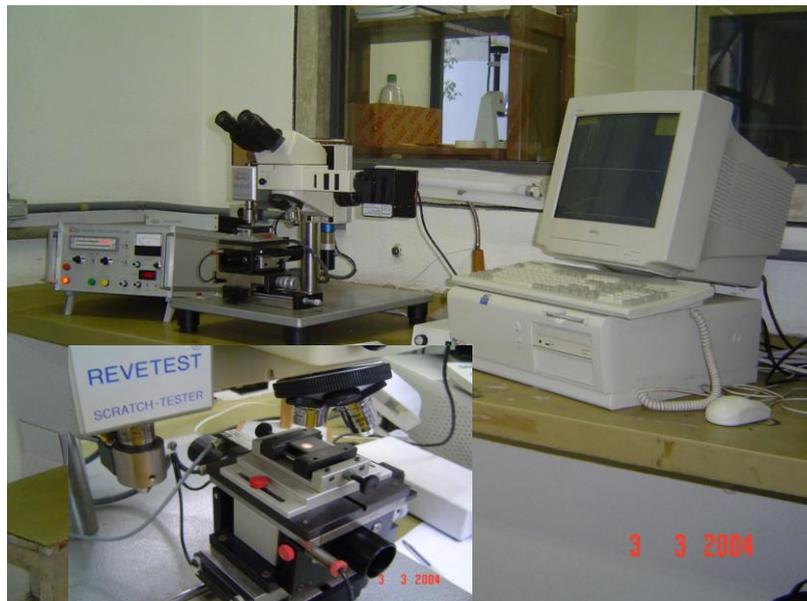
Figura 4.1. Equipamento de ensaio da adesão prática por riscamento Revetest<sup>®</sup>. Em detalhe o sistema de aplicação de carga com emissão acústica e o sistema de observação dos eventos.
