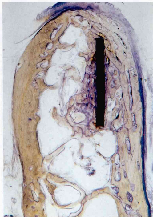
図14：Ti-Ni板（表面非硝酸酸化処理）埋入下顎 骨研磨標本 埋入後6カ月，（トルイジン青染色），×5
