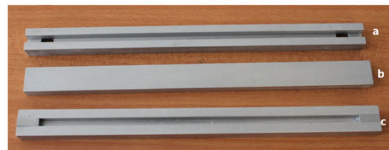
Gambar 2. Cetakan dan pemegang spesimen ekspansi termal linier. a. pemegang spesimen, b. tutup cetakan, c. cetakan. Sumber: Dokumentasi Pribadi
