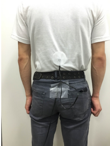
図1 加速度センサ貼付位置
