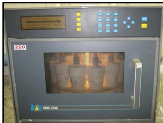
**Figura 11.** Amostras em processo de digestão no microondas
