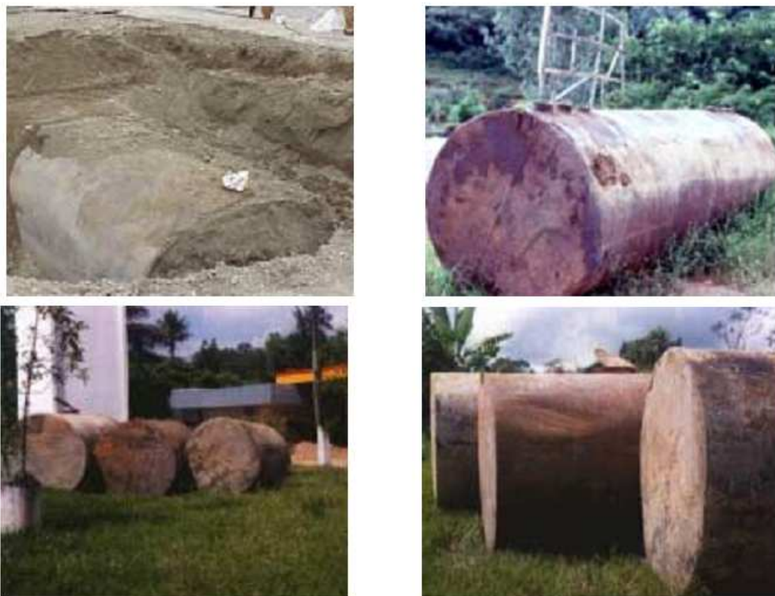
Figura 4: Tanques de gasolina com problemas de corrosão
