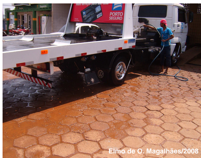
Figura 14: Lavagem de veículo em piso inadequado e sem contenção de resíduos
