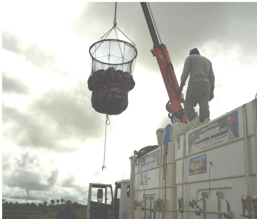
**Figura 7** – Caminhão dotado de braço mecânico para realização de despesca, transporte e armazenamento do pescado em empreendimento de piscicultura localizado no município de Ariquemes-RO. Fonte: Xavier (2011).
