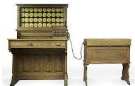
Figura 5: Máquina tabuladora de Hermann Hollerith
