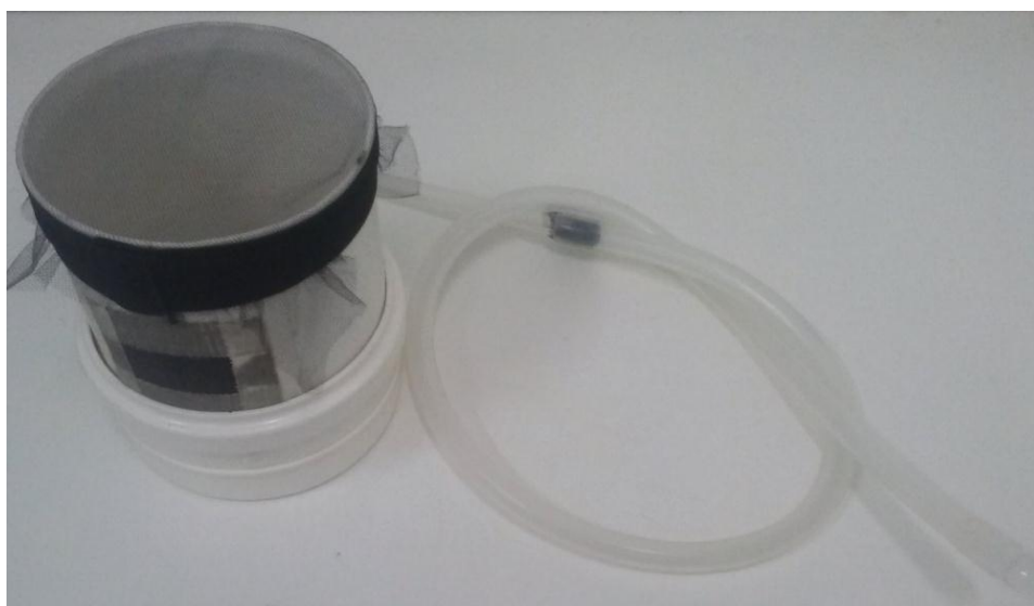
Figura 5. Capturador de castro - Copo/gaiola com tela e entrada de borracha para armazenagem dos mosquitos capturados em campo durante o projeto MONVET
