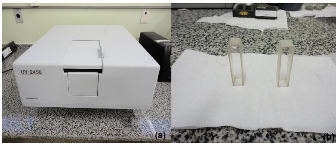
Figura 12: (a) Espectrofotômetro UV/VIS (Shimadzu); (b) Cubetas de análise
