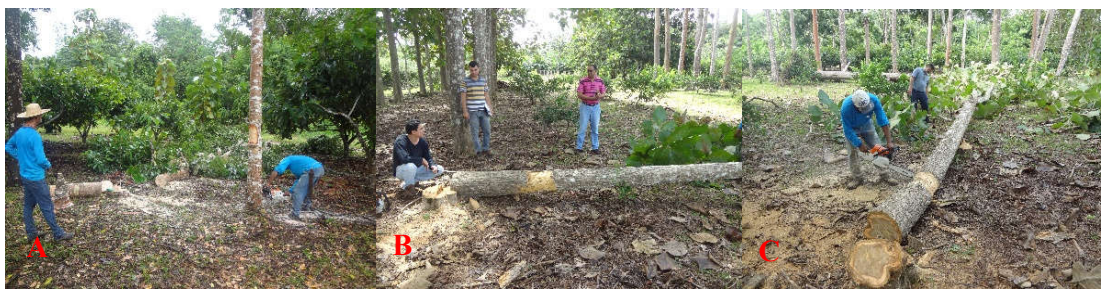
Figura 14 – Retirada das amostras de madeira para os testes físicos-mecânicos em sistema agroflorestal na CEPLAC, Ouro Preto do Oeste – RO. Abate da árvore para retirada da tora (A), medição do ponto de seccionamento da tora a 150 cm da base do fuste (B) e retirada da tora (C).
