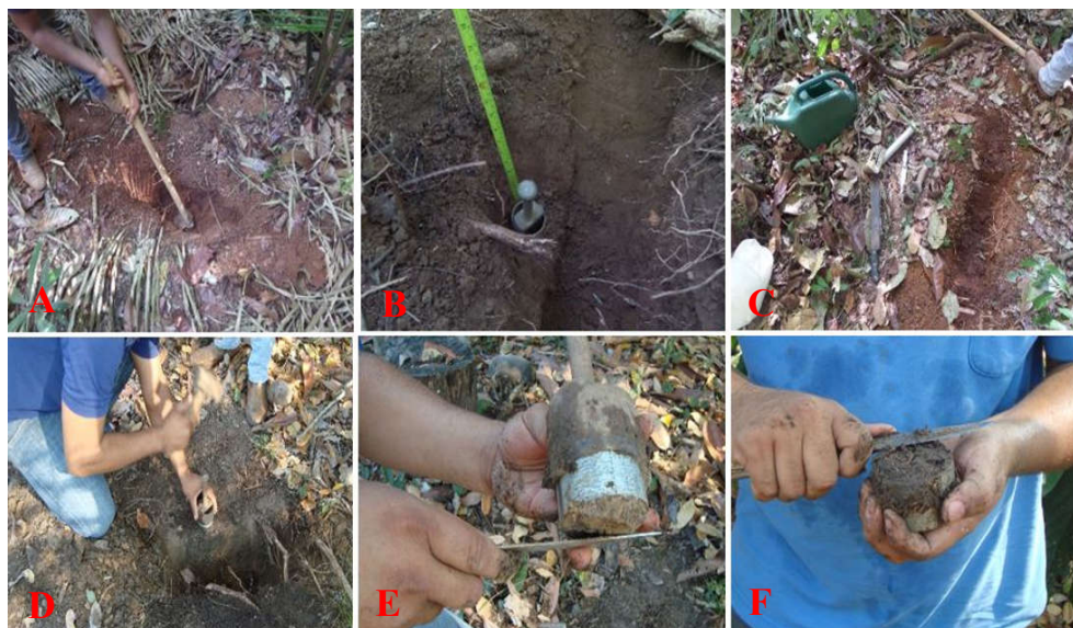
Figura 12 – Processo de coleta de amostras de solo indeformadas na CEPLAC, Ouro Preto do Oeste – RO. A – Escavação da trincheira; B – Medição da profundidade desejada para coleta; C – Trincheira pronta; D – Processo de coleta; E – Amostra recém retirada; F – Toaleta das amostras.
