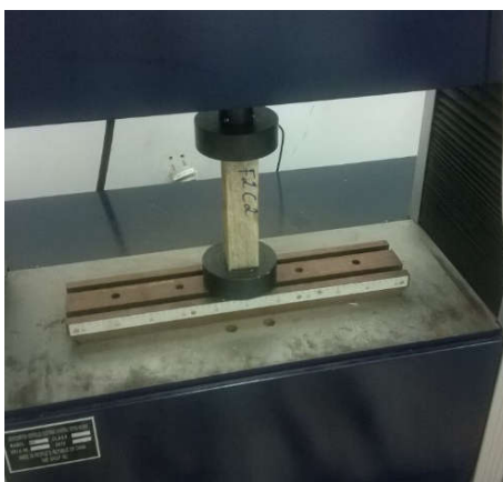
Figura 2 – Ensaio de compressão paralela às fibras e posicionamento do corpo-de-prova no equipamento.
