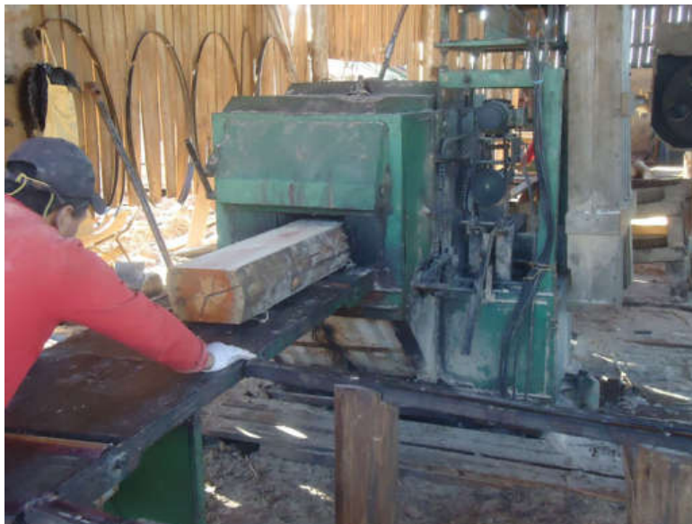
Figura 15 – Exemplo de serra circular utilizada para o desdobro primário das toras e confecção dos blocos de madeira para retirada dos corpos-de-prova.
