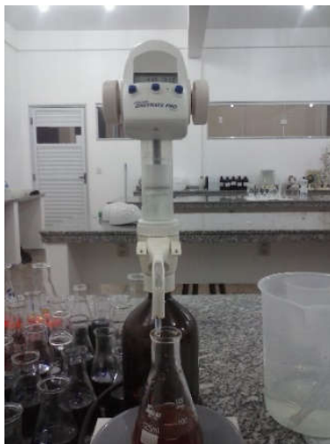
Figura 13 – Titulação das amostras com sulfato ferroso amoniacal para determinação do teor de COS.
