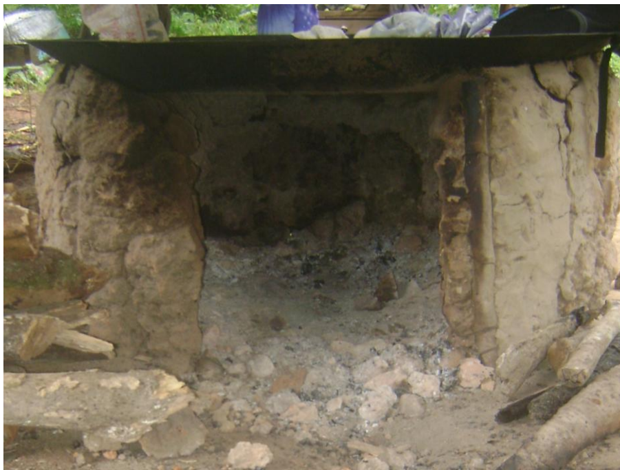
Foto 18: LOPES, Luciane Gomes. Forno utilizado para o processo de torrar a farinha. Sua base é feita em barro e a parte superior em alumínio batido. Nazaré – RO, 2012.
