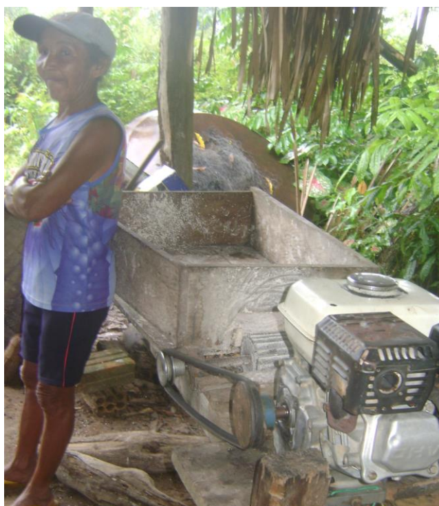
Foto 17: LOPES, Luciane Gomes. Maquinário utilizado para moer a macaxeira para preparação de farinha. O aspecto de tal casa de farinha é bem rudimentar, coberta com palhas e maquinário bem antigo e em condições de utilização meio que precárias. Nazaré – RO, 2012.
