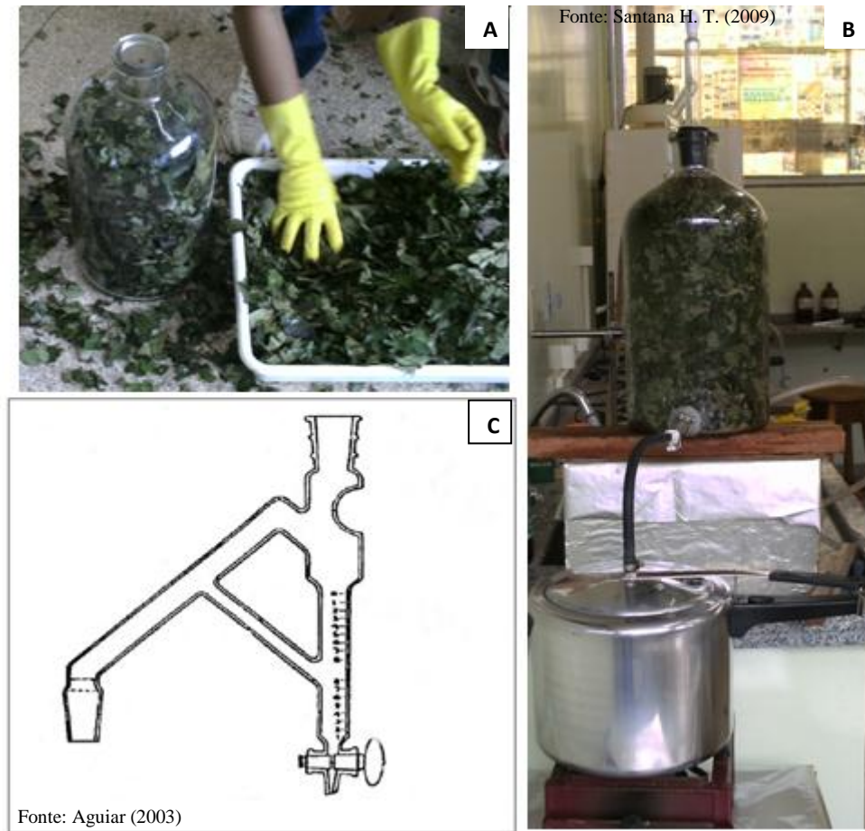
Figura 12- Trituração das folhas (A) para extração do óleo essencial de Piper alatabaccum (B) e desenho esquemático do aparelho de Clevenger modificado (C).
