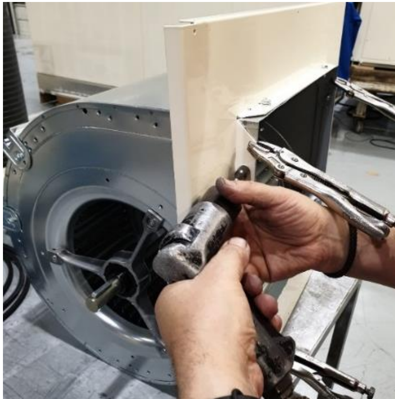
Figura 16. Montaje de una turbina en el marco de una máquina
