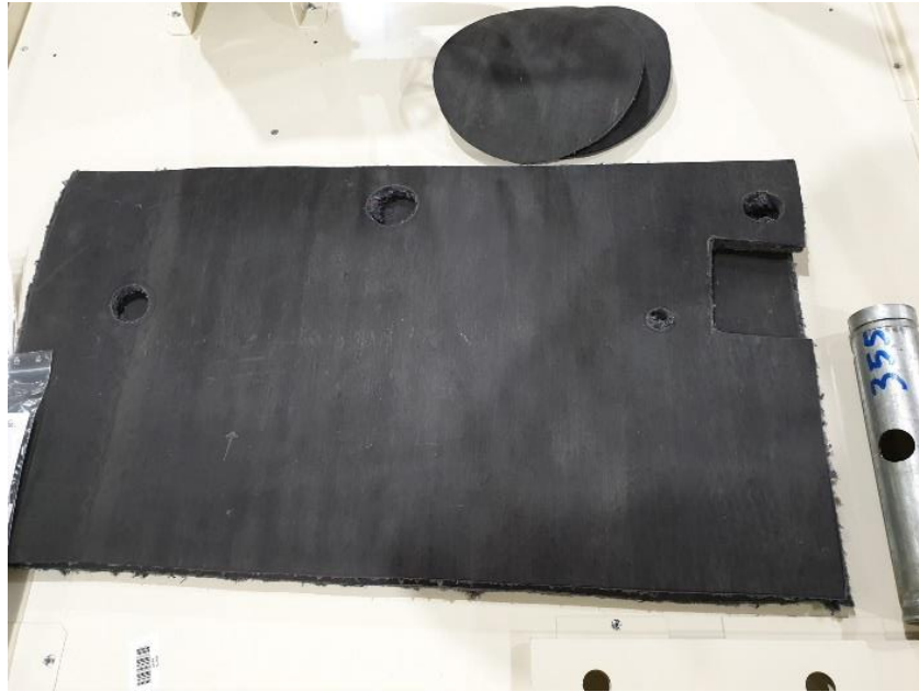
Figura 17. Aislante del compresor ya recortado.
