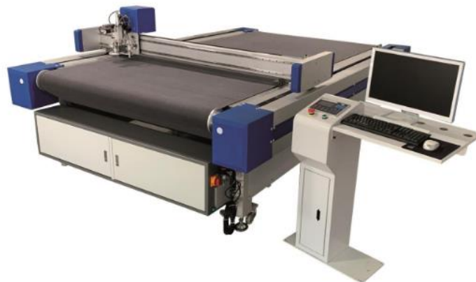
Figura 50. Nueva cortadora láser de aislante de chapa.
