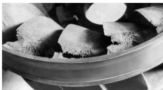
Figura 2.5 Danys causats pels efectes de la cavitació als àleps d'una turbina Francis. Font: An Introduction to Cavitation Fundamentals
