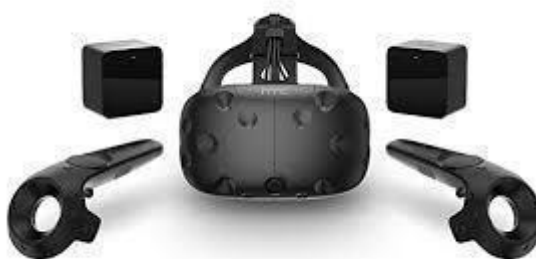
Figura 3.4: Gafas de RV HTC Vive con sensores base y mandos (Fuente: https://www.xataka.com )
