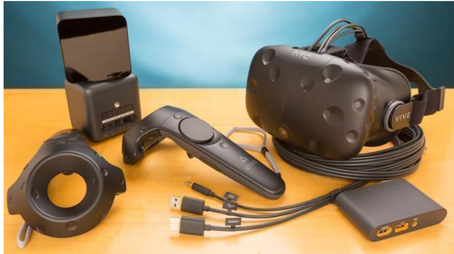
Figura 5.12: Hardware que compone las gafas HTC Vive (Fuente: http://i.imgur.com/hCCSaDB.jpg )
