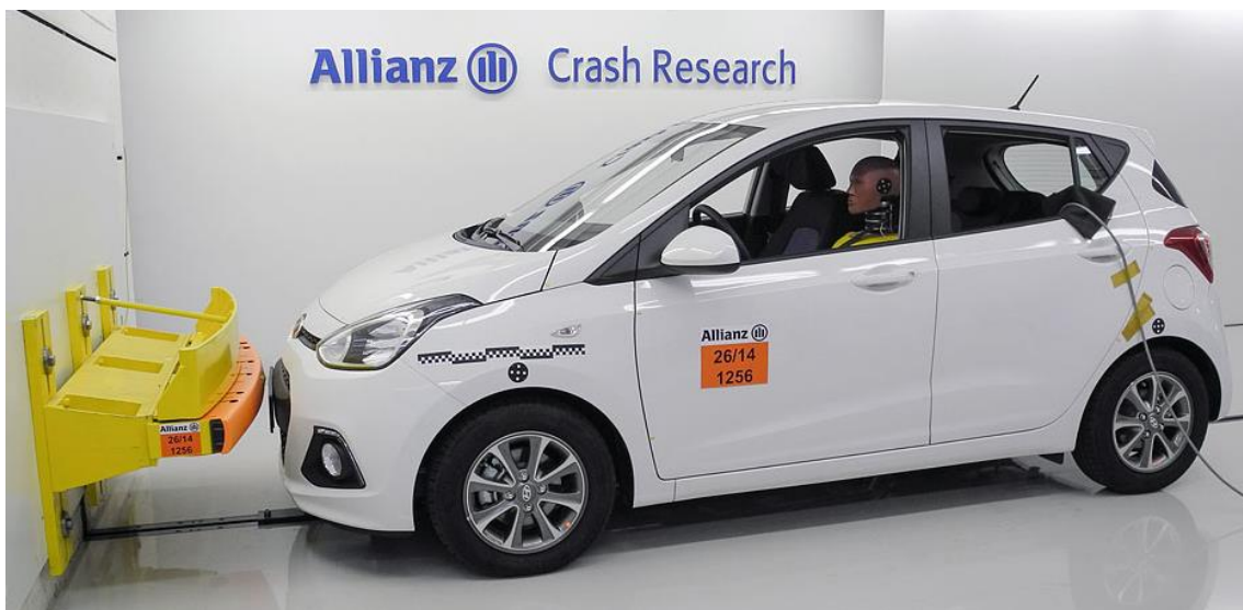
Figura 4. Ensayo RCAR Bumper test realizado por Allianz Seguros.
