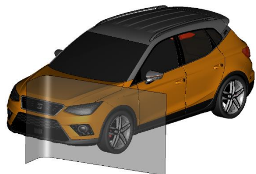
Figura 11. Simulación choque tipo AZT del Seat Arona (Fuente: Seat)
