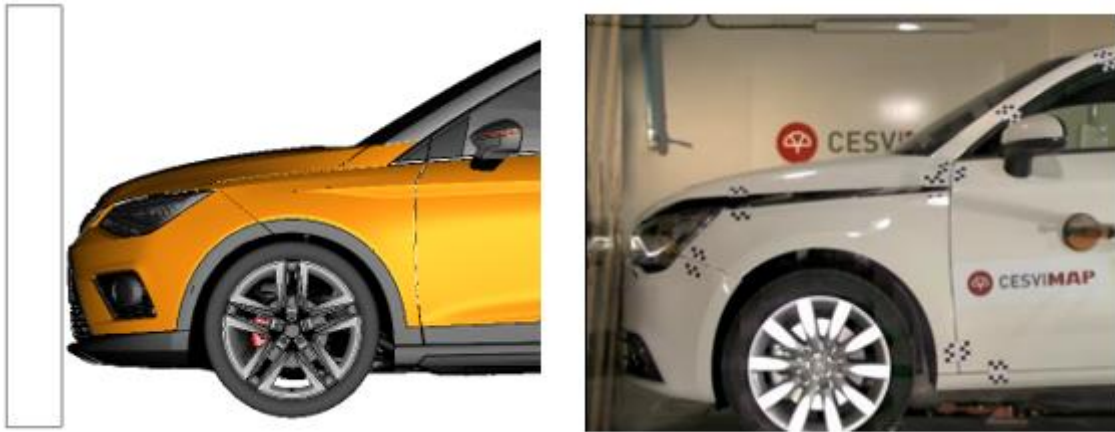
Figura 13. Simulación y choque real tipo pared del Seat Arona (Fuente: Seat)
