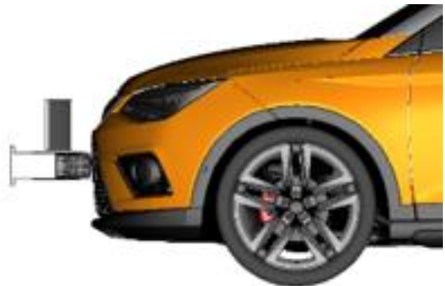
Figura 9. Simulación choque tipo Bumper del Seat Arona (Fuente: Seat)
