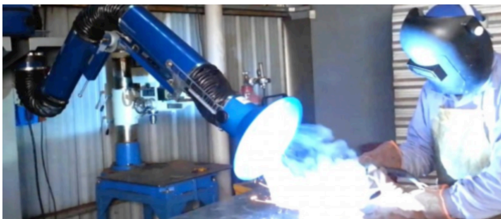
Figura 7.6: Campana d'extracció mòbil
