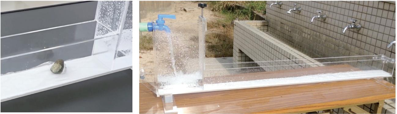
図2 左：水門プレートによるスリット 右：実際に水を流している状態
