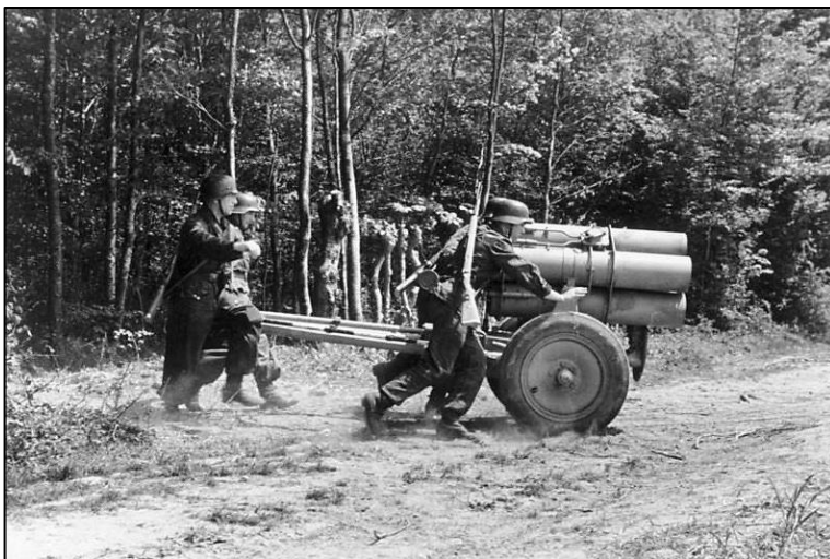
Abbildung 52: Ein 21-cm-Nebel-(Raketen-)Werfer 42 wird in Stellung gebracht, der aus fünf im Kreis angeordneten Abschussrohren bestand.
